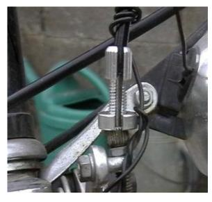
Quando si deve togliere la ruota e si rende necessario allargare le pinze dei freni, è sufficiente ruotare il dado modo la in che fessura quest'ultimo combaci con la fessura della vite, potendo così asportare vite regolazione l'intera di ottenendo un allungamento della fune di acciaio di circa 2 cm. normalmente sufficienti alle necessità.
